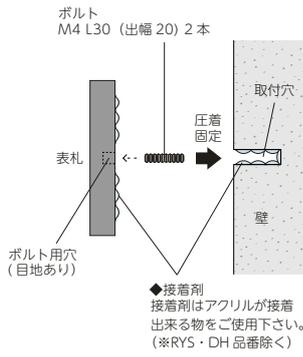
裏側にボルト用の穴が開いていますので付属のボルトを回し込み固定します。
