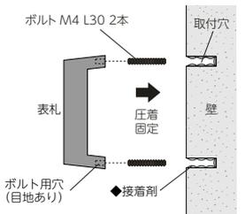
裏側にボルト用の穴が開いていますので付属のボルトを回し込み固定します。
