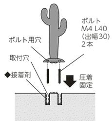
ボルト用の穴が開いていますので付属のボルトを回し込み固定します。
