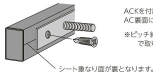
ACKを付属のドリルビットを使いAC裏面に固定してください。
