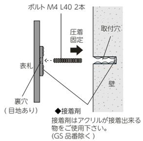
裏側にボルト用の穴が開いていますので付属のボルトを回し込み固定します。
