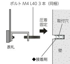
アクセントラインと組み合わせて施工する場合はアクセントラインを先に壁へ取り付ける必要があります。
