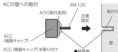
ACC (樹脂キャップ)を取り付ける場合は壁面に固定する前に取付けて下さい。
