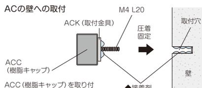
ACC(樹脂キャップ)を取り付ける場合は壁面に固定する前に取り付けて下さい。
