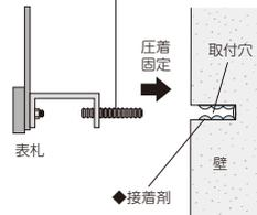
アクセントラインと組み合わせて施工する場合はアクセントラインを先に壁へ取り付ける必要があります。
