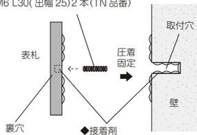
◆接着剤 必ず接着剤を併用して取り付けて下さい。
