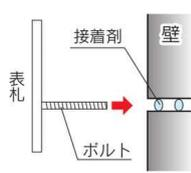
1. 壁にドリルでボルト径より1～2mm大きめの穴をあけてください。
