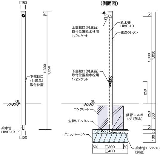
※左右の記載のない側面図は正面に対して右側を表示しています。
