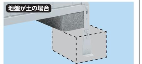
付属品のアジャスタブルアンカープレートを使用して、転倒防止工事を行ってください。アンカーは柱下部4ヶ所で行います。(大型タイプは6ヶ所です)
