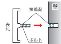
1. 壁にドリルでボルト径より1~2mm大きめの穴をあけてください。
