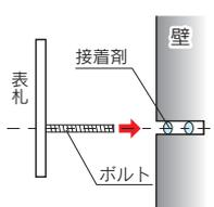
1. 壁にドリルでボルト径より1~2mm大きめの穴をあけてください。
