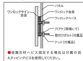
●金属芯材へビス固定する場合は付属の皿Aタッピングビスを使用してください。
